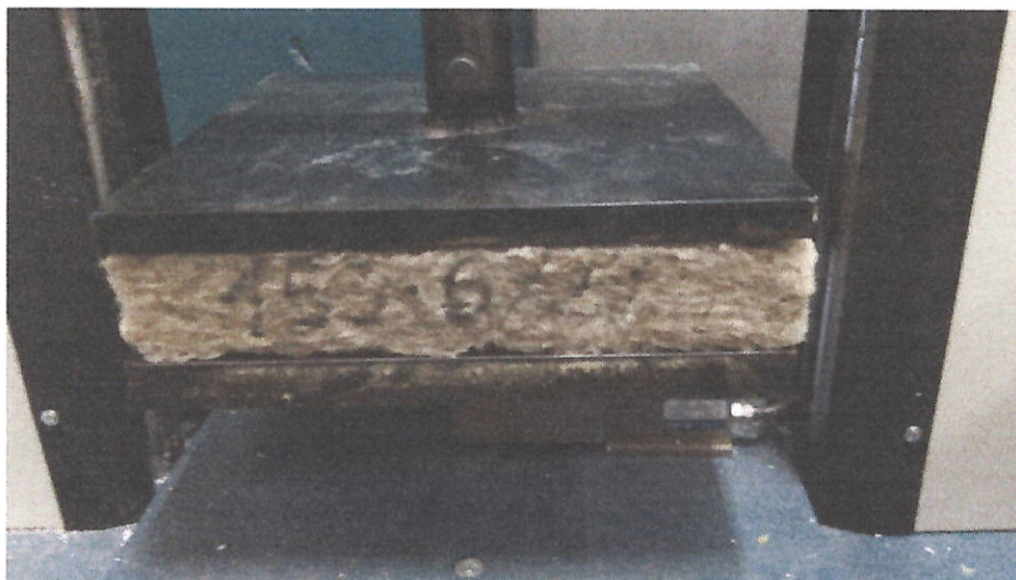
Рисунок 5 – Проведення випробування стисливості зразків теплоізоляційного матеріалу марки «ТЕХНОЛАЙТ ЕКСТРА»
