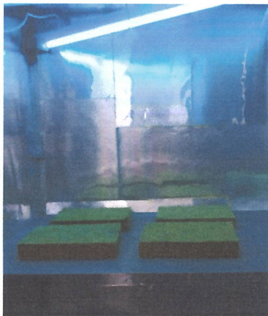
Рисунок 7 – Загальний вигляд дослідних зразків теплоізоляційного матеріалу марки «ТЕХНОЛАЙТ ЕКСТРА» під час опромінення
